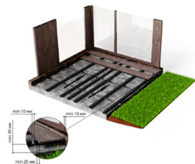
Рис. 3. Укладка доски на лагу.
